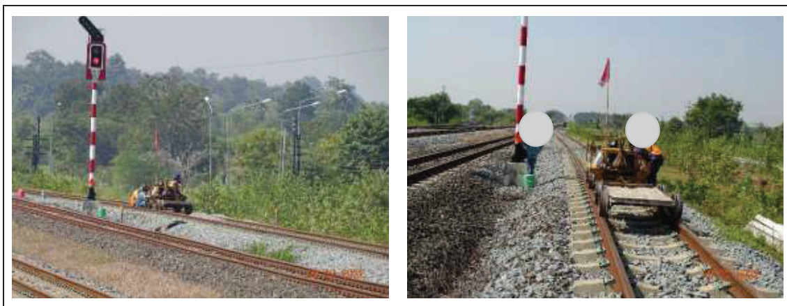
รูปที่ 2.2-15 รถยนต์ราง (รถตีก) ซึ่งมีไว้สำหรับตรวจสอบทางรถไฟโดยนายตรวจทาง
